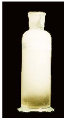
Ilustracja 2: przesycona azotem woda grzewcza po pobraniu próbki
