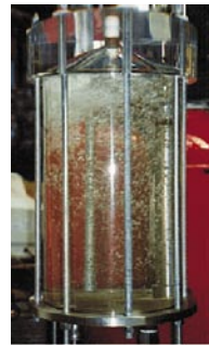
ilustracja 11: dynamiczne odgazowywanie na stanowisku testowym 'servitec'
