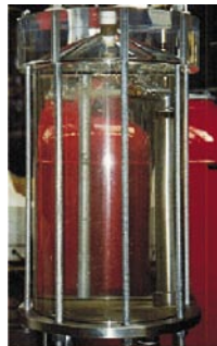
ilustracja 10: statyczne odgazowywanie próżni w „spokojnej próżni”
